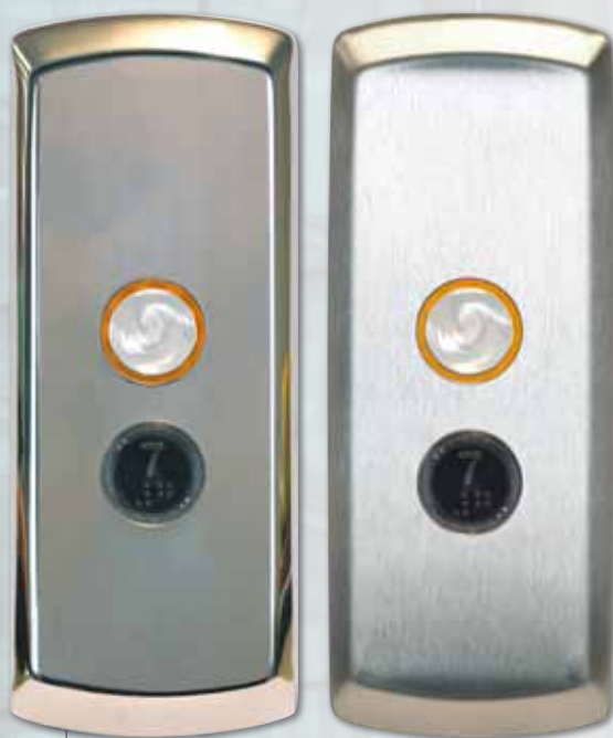
Bottoniera di piano con placca in cromo lucido o satinato. Pulsante cromo lucido con anello di segnalazione arancio. Gemma di segnalazione allarme e indicazioni Braille.
